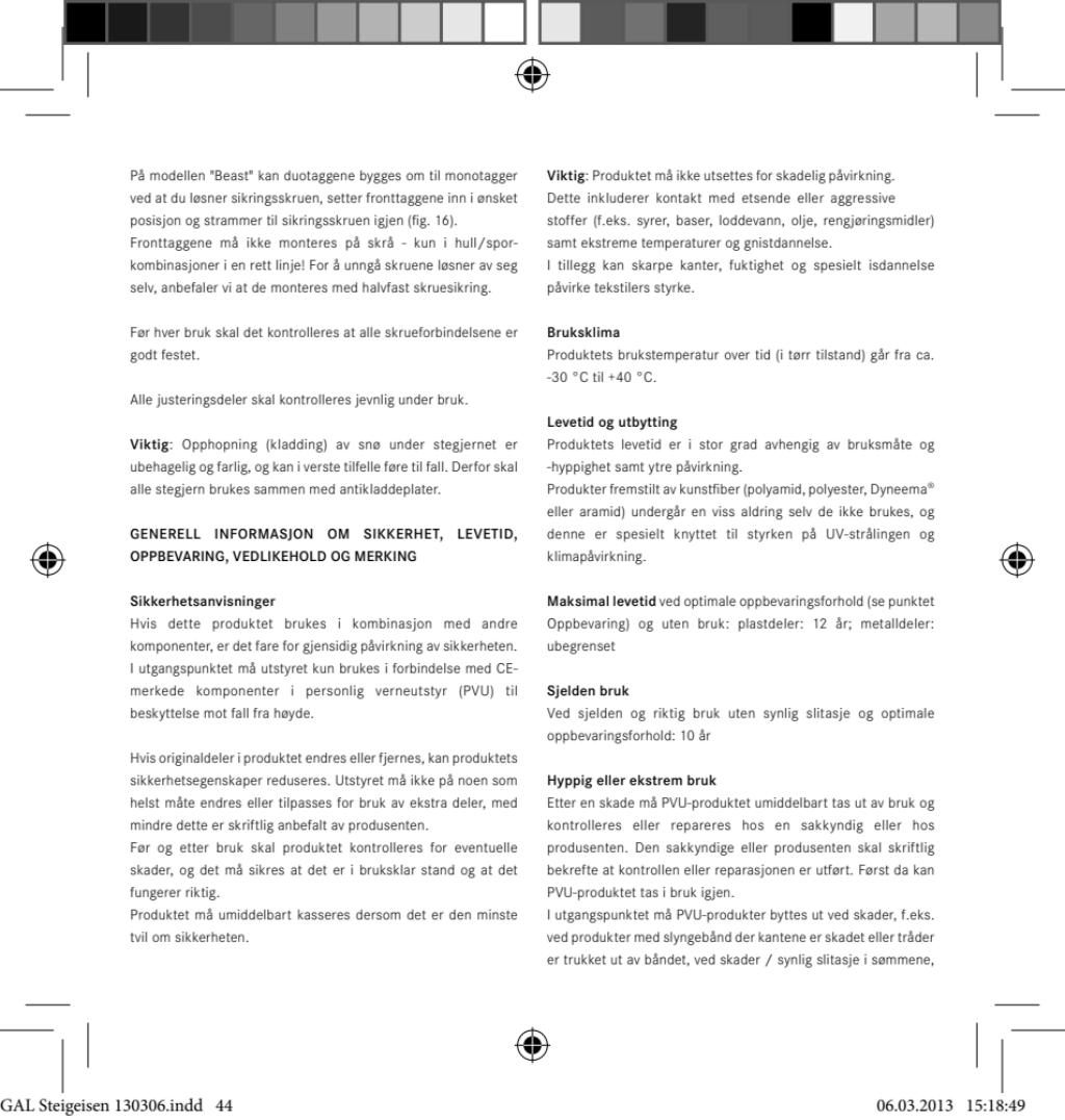
På modellen "Beast" kan duotaggene bygges om til monotagger ved at du løsner sikringsskruen, setter fronttaggene inn i ønsket posisjon og strammer til sikringsskruen igjen (fig. 16). Fronttagene må ikke monteres på skrå - kun i hull/sporkombinasjoner i en rett linje! For å unngå skruene løsner av seg selv, anbefaler vi at de monteres med halvfast skruesikring.
