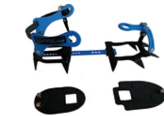
Die Antistollplatte besteht aus einem Vorder- und einem Hinterteil. Für die Montage muss das Steigeisen geteilt werden. **Wichtig!** Die glatte Seite der Antistollplatte liegt unten.
