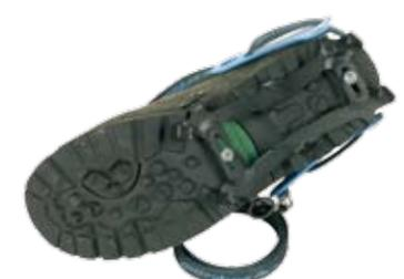
Fußleisten auf Schuhgröße anpassen und Fixieren der Verstellerschrauben.
