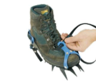
Gurt durch die Öse des Vorderteiles führen.
